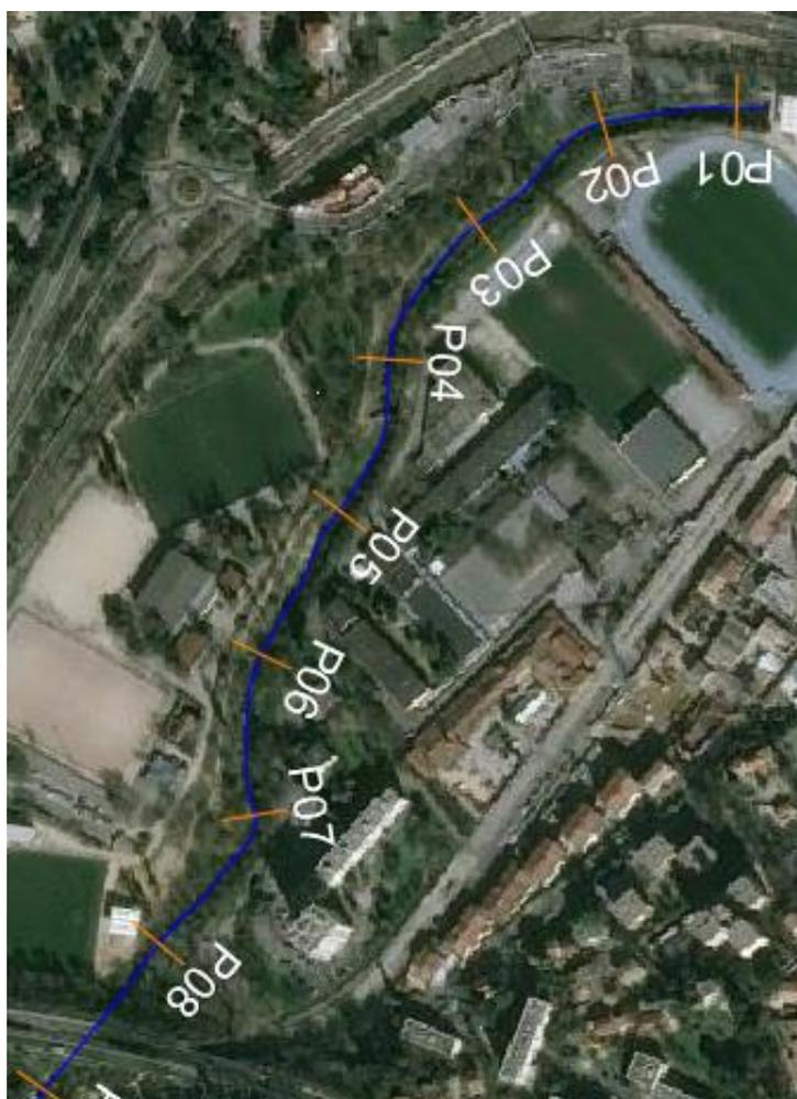
Figure 56 : Localisation des profils en travers état initial
